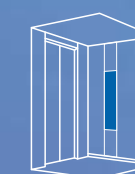
Установка боковой стенки кабины
