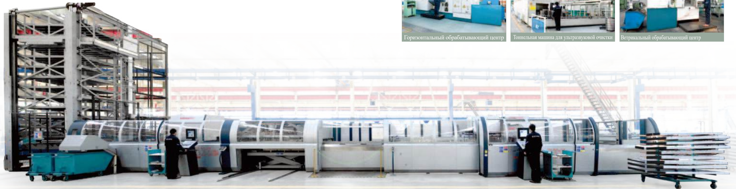
Линия производства комплектных и гибких изделий из листового металла Salvagnini(S4+P4), Италия
